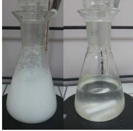
Şekil 2. Alüminyum tri-sec-bütoksitin hidrolizi.
