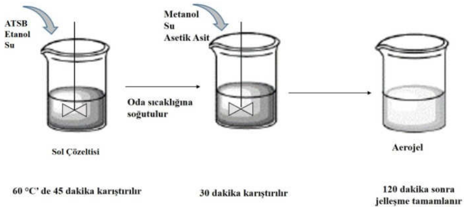
Şekil 3. Alümina aerojel sentezinin şematik gösterimi.
